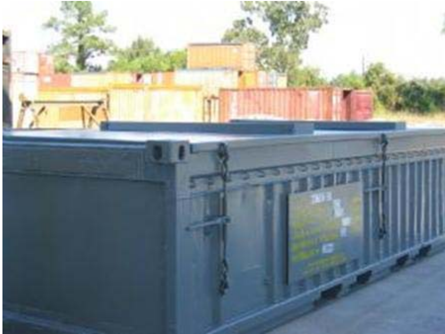
3.6 pav. 20 pėdų pusės aukščio ISO konteineris su nuimamu plieniniu dangčiu
