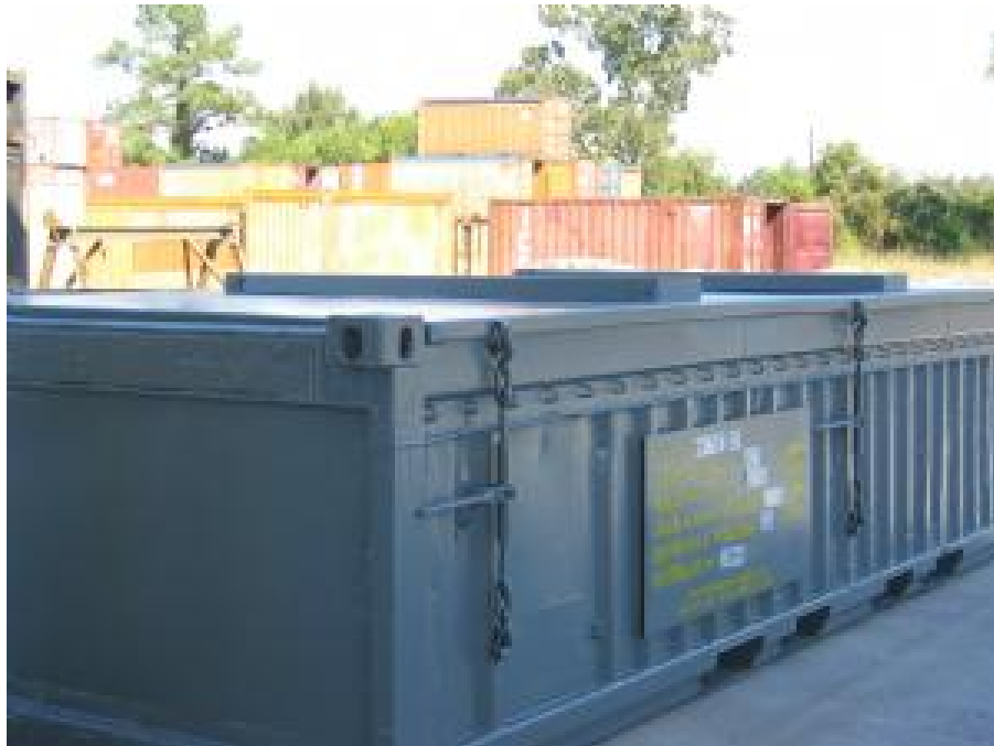
2.2 pav. 20-ies pėdų pusės aukščio ISO konteineris su nuimamu plieniniu dangčiu
