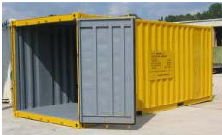
2.3 pav. 20 pėdų ISO konteinerio variantai su visiškai atidaromu šonu ir durimis gale
