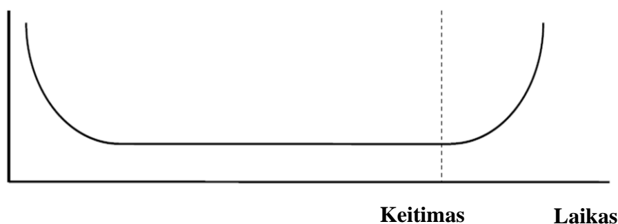
13.2-2 pav. Tipinė įrangos gedimų skaičiaus pokyčių priklausomybė laikui bėgant
