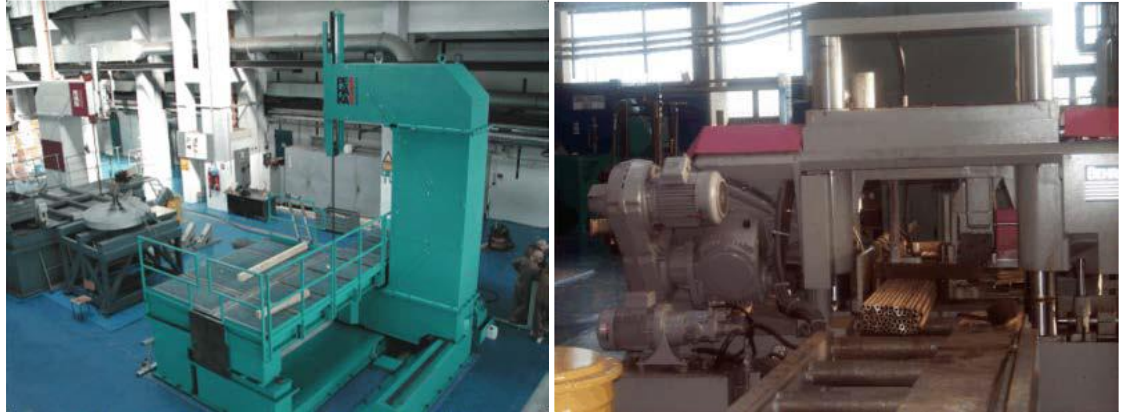
12.4-16 pav. Pjovimas naudojant automatinį juostinį pjūklą
