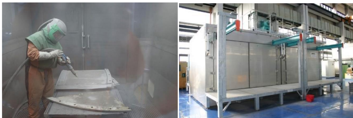
12.4-11 pav. Mechaninė dezaktyvacija (šratasraučiai įrenginiai);
