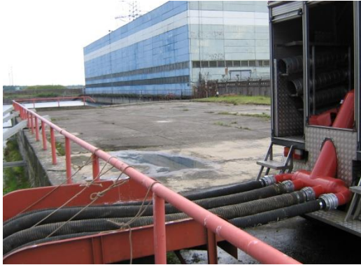
7.1-4 pav. Vandens tiekimas iš Drūkšių ežero naudojant ugniagesių automobilį
