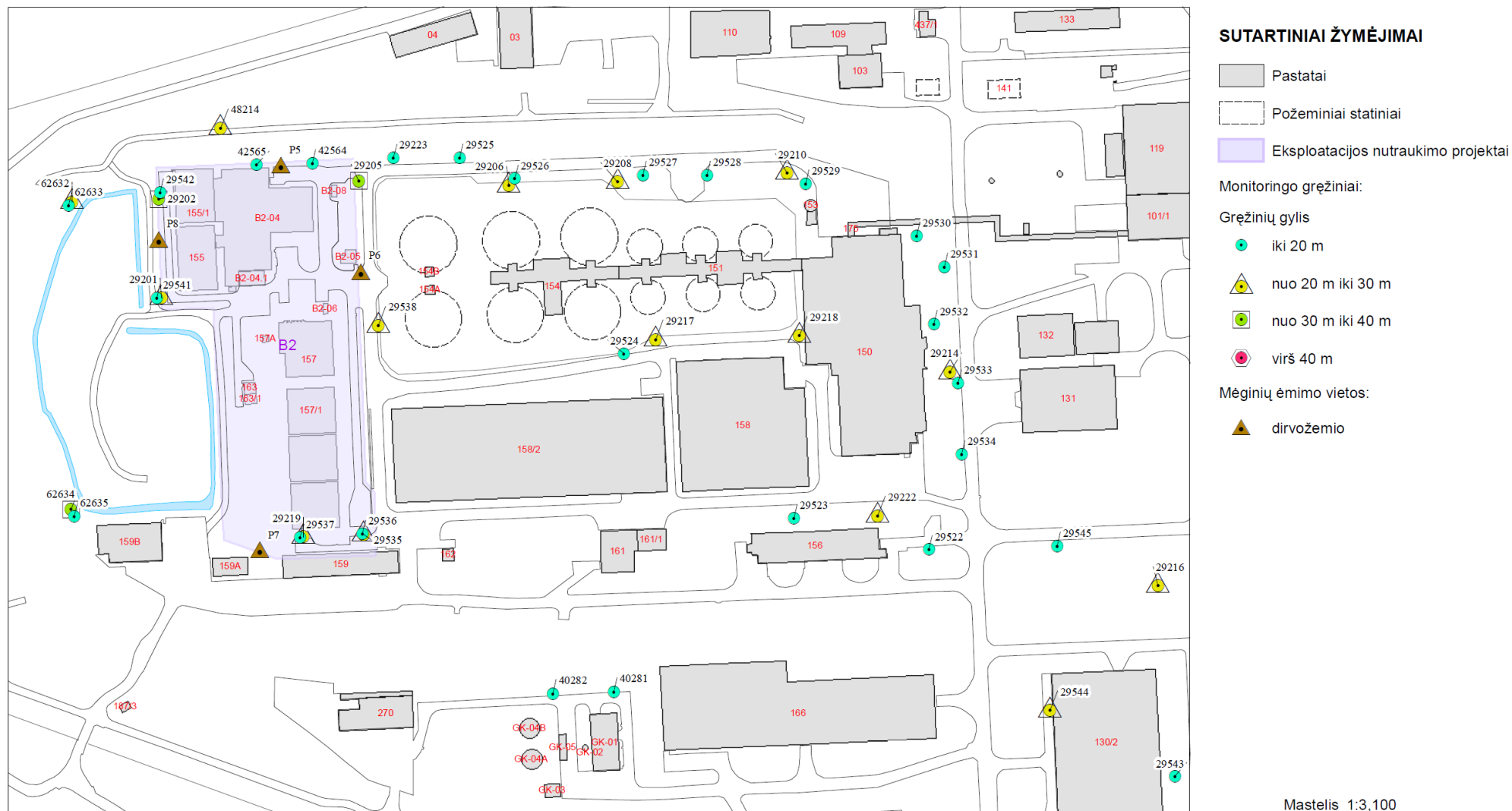
3.2-7 pav. IAE teritorijos stebėjimo gręžinių, skirtų RA saugykloms kontroliuoti, tinklas
