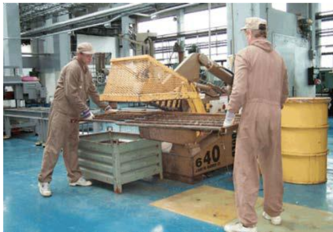
12.4-17 pav. Pjovimas hidraulinėmis žirkklėmis
