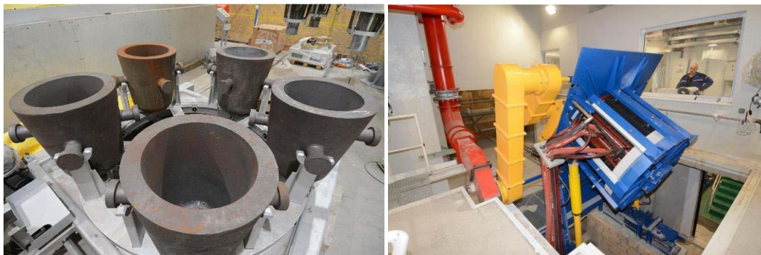
12.4-1 pav. Karuselinis mechanizmas su kokiliais. Indukcinė, metalą lydanti krosnis.
