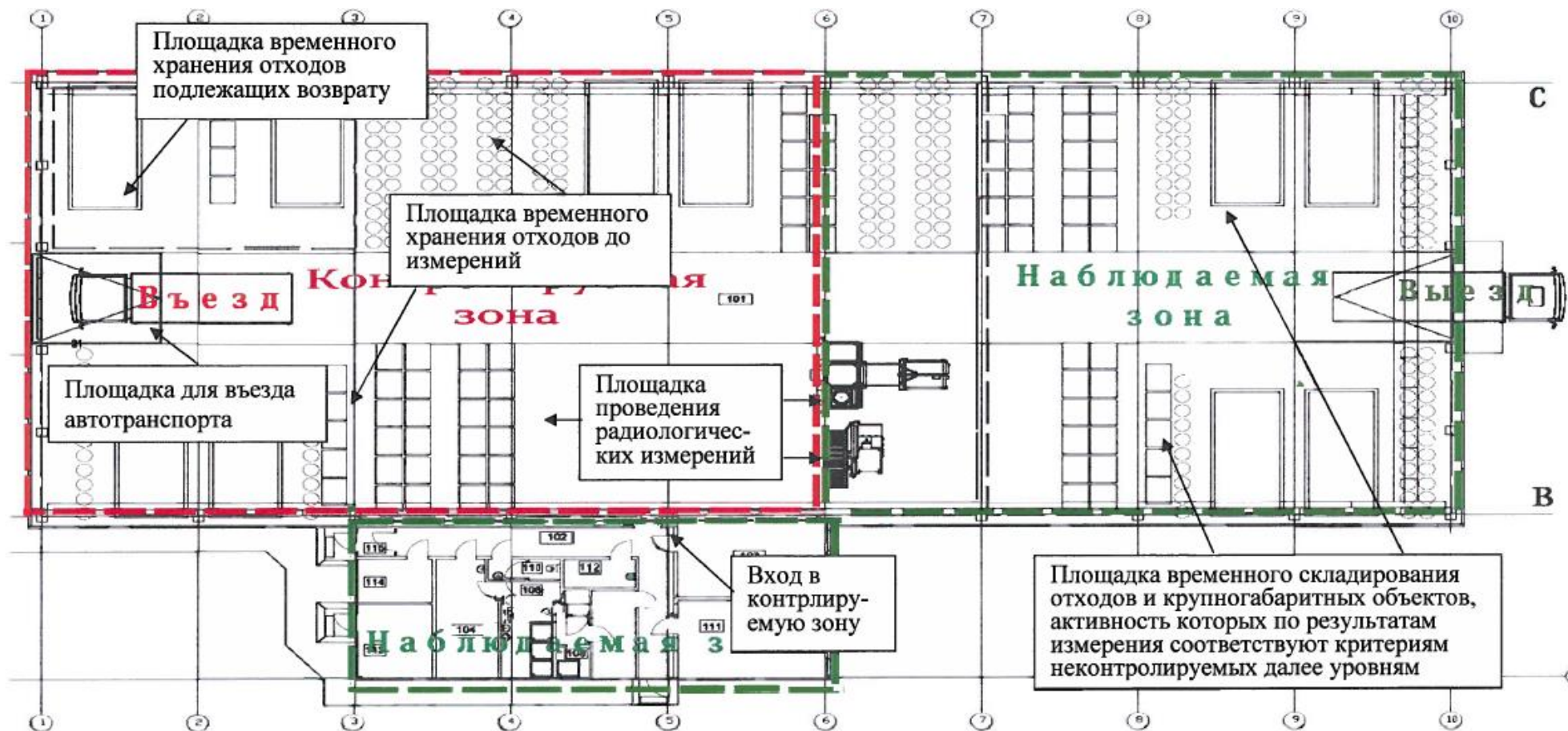
2.8-3 pav. B10 komplekso patalpų planas
