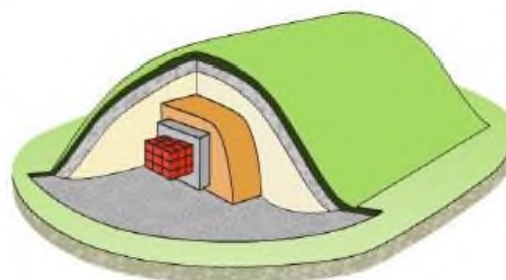
Pav. 1.3-9 Paviršinio atliekyno konceptualusis vaizdas, atliekų krovimo schema
